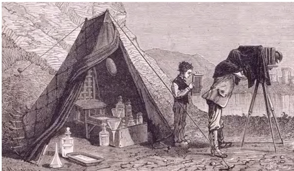
Dispositif complet de prise de vues et de développement pour les photographes-voyageurs.
